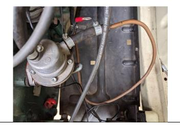
10 - Brancher le fil vert sur la borne rupteur de l'allumeur.
